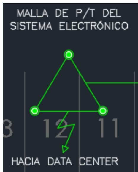
Figura 3 Malla de puesta a tierra de equipos electrónicos.
